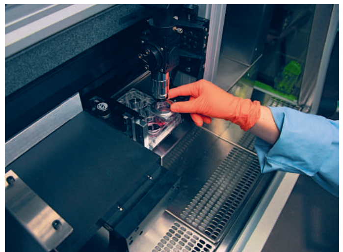
Durch Laser gestützte Bioprinting Arbeitsstation – entwickelt durch das INSERM an der Universität Bordeaux. (Bild: INSERM)
